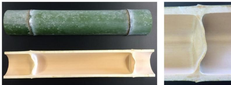
図 1. タケの切断面。節間板という板が中空部分に挿入されているため、タケ全体が曲がりにくくなっている。[Phys. Rev. E **93** (2016) 022406]
