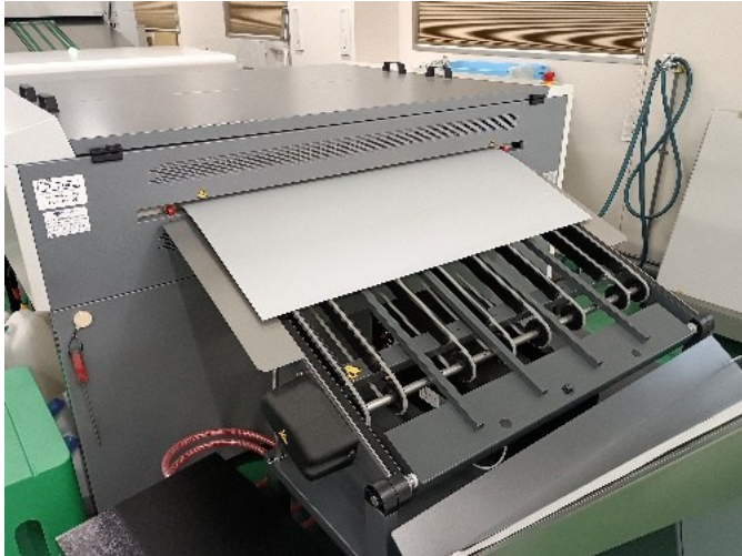
写真1 刷版ができあがるところ（原版はアルミ製）
